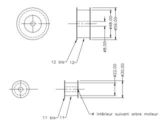
L'entraînement en rotation pour l'usinage est confié quant à lui à de la durit caoutchouc, et l'usinage se fera à la lime électrique ou à l'ébarbeuse munie d'un disque à lamelles, avec contrôle très fréquent de la cylindricité (ne pas faire un cône) et du diamètre au pied à coulisse. Une dernière chose, ne pas démonter les poulies après usinage, au risque de perdre la concentricité. Les flasques des poulies 11 et 12 bis sont découpées elles aussi à la scie cloche, et collées à la cyano.
